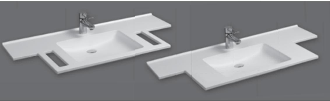
Einzelwaschtisch in einem Stück nach Maß gegossen, Mehrfachwaschtisch aus mehreren Einzelwaschtischen fugenlos miteinander verklebt und fertig konfektioniert, unterfahrbar, Materialstärke im Ablagebereich 20 mm, mit vorgezogenem rechteckigem Becken, ohne Überlauf, Hahnlochbohrung optional, mit Wandanschlussprofil 10 mm mit Hohlkehle, Tiefe 550 / 250 mm, Multifunktionsausschnitt rechts und/oder links optional, mit Rückwand für Stockschraubenbefestigung.
