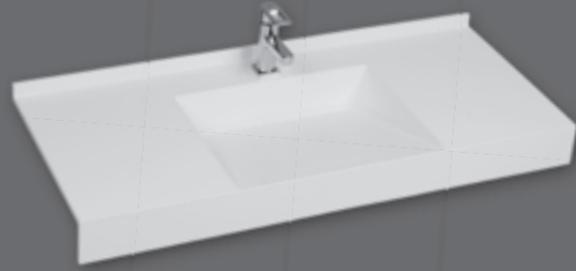
Einzelwaschtisch in einem Stück nach Maß gegossen, Mehrfachwaschtisch aus mehreren Einzelwaschtischen fugenlos miteinander verklebt und fertig konfektioniert, unterfahrbar, mit rechteckigem, schräg zur frei zugänglichen Wasserablauffrinne verlaufendem Becken, mit direktem Übergang in die Ablauföffnung, ohne Überlauf, Hahnlochbohrung optional, mit Frontblende 100 mm, mit Wandanschlussprofil 30 mm mit Hohlkehle, Tiefe 520 mm, Handtuchhalterausschnitt optional.
