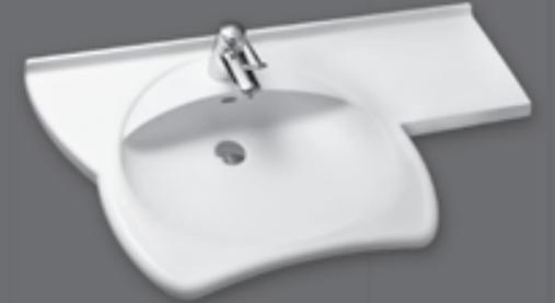
Einzelwaschtisch in einem Stück nach Maß gegossen, Mehrfachwaschtisch aus mehreren Einzelwaschtischen fugenlos miteinander verklebt und fertig konfektioniert, mit ovalem Becken, mit oder ohne Überlauf, mit leicht nach unten abgesetzter Hahnbank, Hahnlochbohrung optional, mit Frontblende 38 mm, mit integrierter Greifreling an der Beckenkante, mit Wandanschlussprofil 30 mm mit Hohlkehle, Tiefe 550 / 270 mm, Grifflöcher optional, mit Rückwand für Stockschraubenbefestigung.
