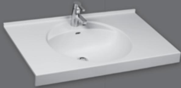
Einzelwaschtisch in einem Stück nach Maß gegossen, Mehrfachwaschtisch aus mehreren Einzelwaschtischen fugenlos miteinander verklebt und fertig konfektioniert, mit rundem Becken, mit oder ohne Überlauf, mit leicht nach unten abgesetzter Hahnbank, Hahnlochbohrung optional, mit Frontblende 70 mm, mit Wandanschlussprofil 20 mm mit Hohlkehle, Tiefe 560 mm.
