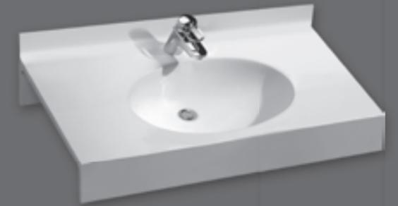
Einzelwaschtisch in einem Stück nach Maß gegossen, Mehrfachwaschtisch aus mehreren Einzelwaschtischen fugenlos miteinander verklebt und fertig konfektioniert, mit ovalem Becken, mit oder ohne Überlauf, Hahnlochbohrung optional, mit Frontblende 200 mm, mit Wandanschlussprofil 80 mm mit Hohlkehle, Tiefe 550 mm, Handtuchhalterausschnitt optional, mit Rückwand für Stockschraubenbefestigung.
