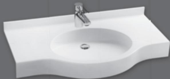
Einzelwaschtisch in einem Stück nach Maß gegossen, Mehrfachwaschtisch aus mehreren Einzelwaschtischen fugenlos miteinander verklebt und fertig konfektioniert, unterfahrbar, mit vorgezogenem ovalem Becken, ohne Überlauf, Hahnlochbohrung optional, mit Frontblende 100 mm, mit Wandanschlussprofil 50 mm mit Hohlkehle, Tiefe 500 / 380 mm, Handtuchhalterausschnitt optional.
