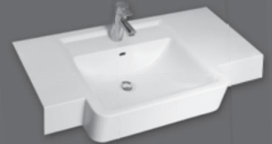
Einzelwaschtisch in einem Stück nach Maß gegossen, Mehrfachwaschtisch aus mehreren Einzelwaschtischen fugenlos miteinander verklebt und fertig konfektioniert, mit vorgezogenem rechteckigem Becken, mit oder ohne Überlauf, mit leicht nach unten abgesetzter Hahnbank, Hahnlochbohrung optional, mit Frontblende 120 mm, Tiefe 480 / 380 mm, Handtuchhalterausschnitt optional.
